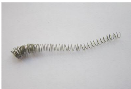
شکل ۵: براده حلزونی شکل نمونه شماره ۲.
