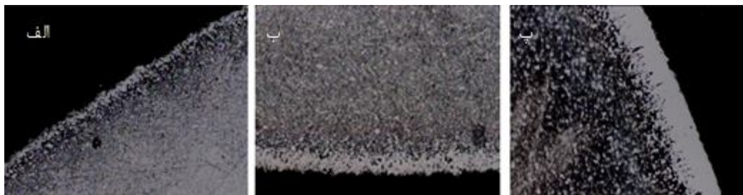
شکل 2. ایجاد پوشش در زمان‌های مختلف (الف) در دو ساعت (ب) در چهار ساعت (پ) در شش ساعت
