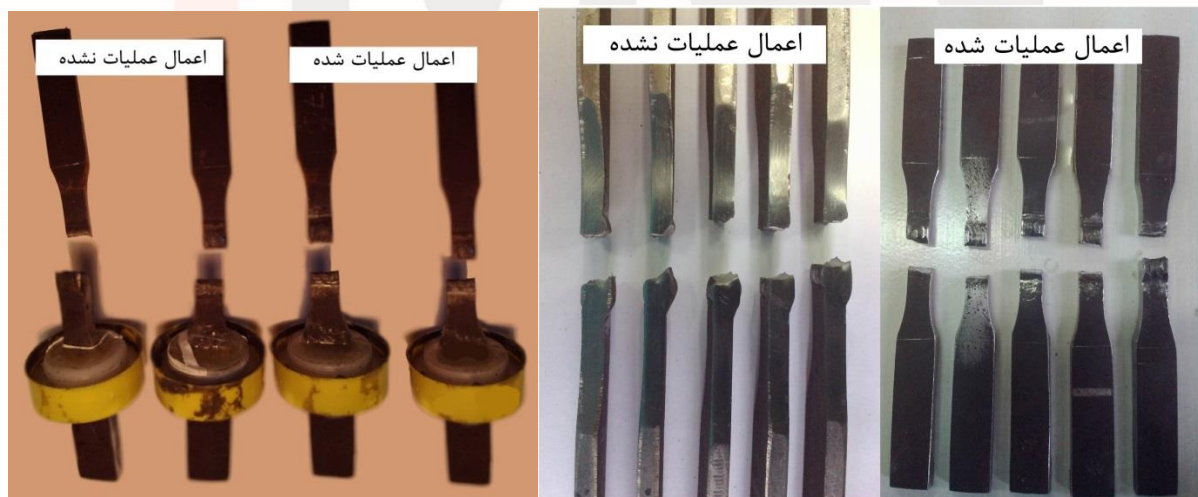
شکل ۷- نمونه‌های آزمون خستگی پس از انجام آزمون (راست). نمونه‌های آزمون خستگی خوردگی پس از انجام آزمون (چپ).
