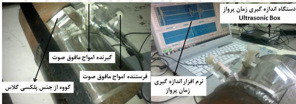
شکل ۶- تجهیزات مورد استفاده در آزمون تحلیل تنش پسماند.
