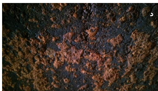
شکل ۲. الف) مسیرهای جریان سیال روی لوله‌ی کویل. ب) نمایی از داخل گرمکن و موقعیت لوله‌های مشعل در داخل بدنه گرمکن، ج) آثار خوردگی در لوله‌ی مشعل، د) آثار تاول مانند خوردگی در سقف گرمکن.
