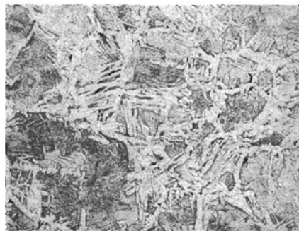
شکل ۲-۱۵ تصویر میکروسکوپی فریت پرویوتکتوئید در قالب صفحات ویدمن اشتاتن در فولاد ۰.۴٪C، Fe. محلول حکاکی نایتال، بزرگنمایی × ۲۰۰ [۱].
