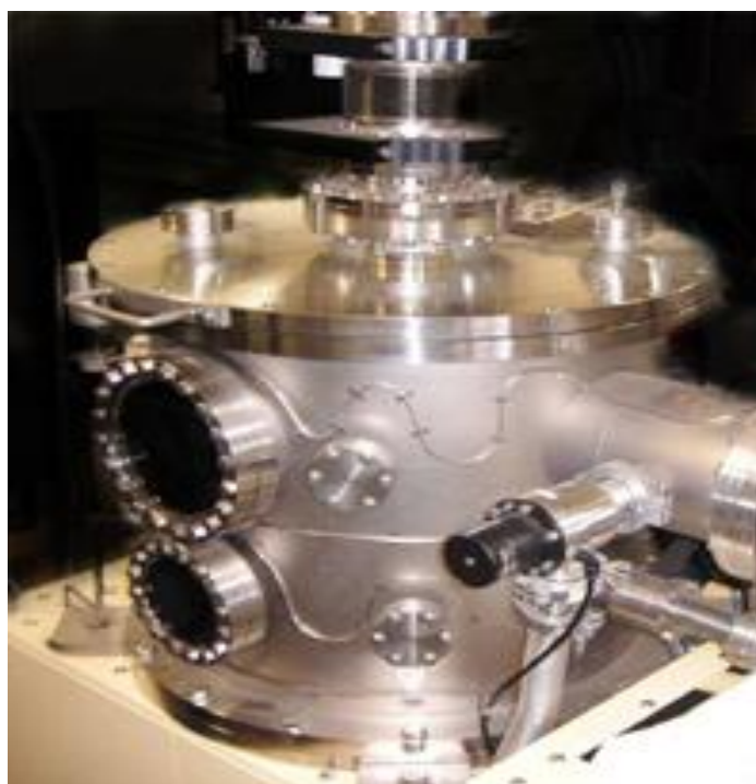
شکل ۶. نمایی از کوره خلأ قوس الکتریکی در شرایط آزمایشگاهی
